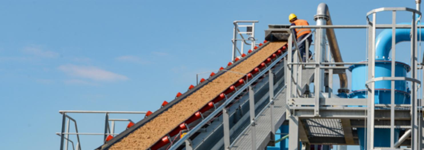
Die **AggreSand™** ist eine moderne semimobile Nassaufbereitungsanlage mit hervorragenden Leistungsdaten für ein breites Materialspektrum. Die vielseitige modulare Waschanlage kann schnell und einfach installiert werden. Der Installationsaufwand ist Dank des großen Anteils werksseitiger Vormontage und Anschlussvorbereitung in jedem Fall deutlich geringer als bei herkömmlichen Modellen.
